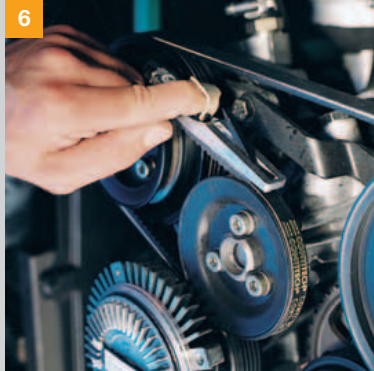
CONTI® BTT Hz (Belt Tension Tester): Elektronische Alternative der Spannungsmessung bei Keilrippenriemen
